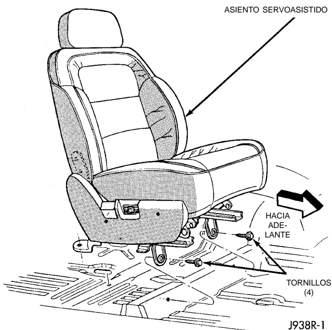
Fig. 4 Desmontaje e instalación de asiento servoasistido - característico
